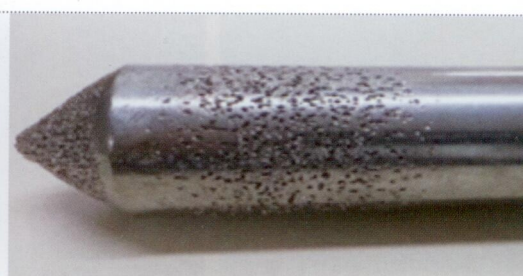
A sinistra, oscillatore a barra dopo l'uso in un impianto di depurazione per circa 9 mesi. Nella figura a destra si osserva chiaramente che il campo sonoro non è omogeneo per gli oscillatori a barra. Vi sono aree che non sono assolutamente interessate dalla cavitazione
