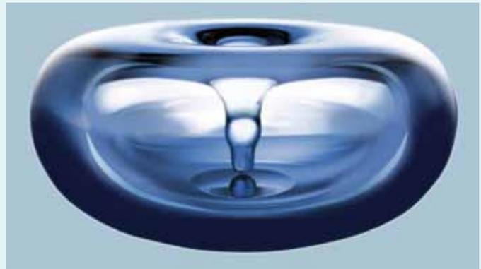
Vielfach vergrößerte Kavitationsblase bei einer Frequenz von ca. 25 kHz unmittelbar vor der Implosion.
