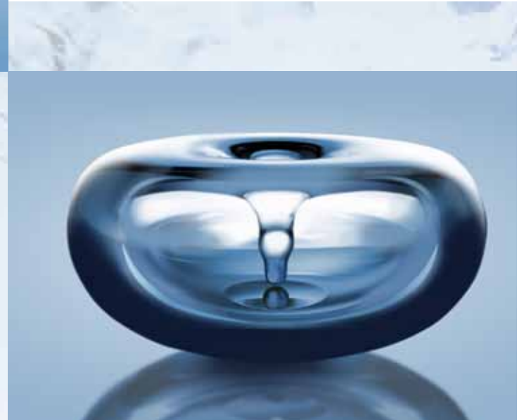
Vielfach vergrößerte Kavitationsblase bei einer Frequenz von ca. 25 kHz zum Zeitpunkt der Implosion
