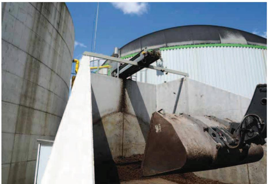
**Im Separator wird ein Teil der Gärreste in flüssige und feste Bestandteile getrennt. Die flüssige Fraktion geht als Rezirkulat zurück in den Fermenter.**
