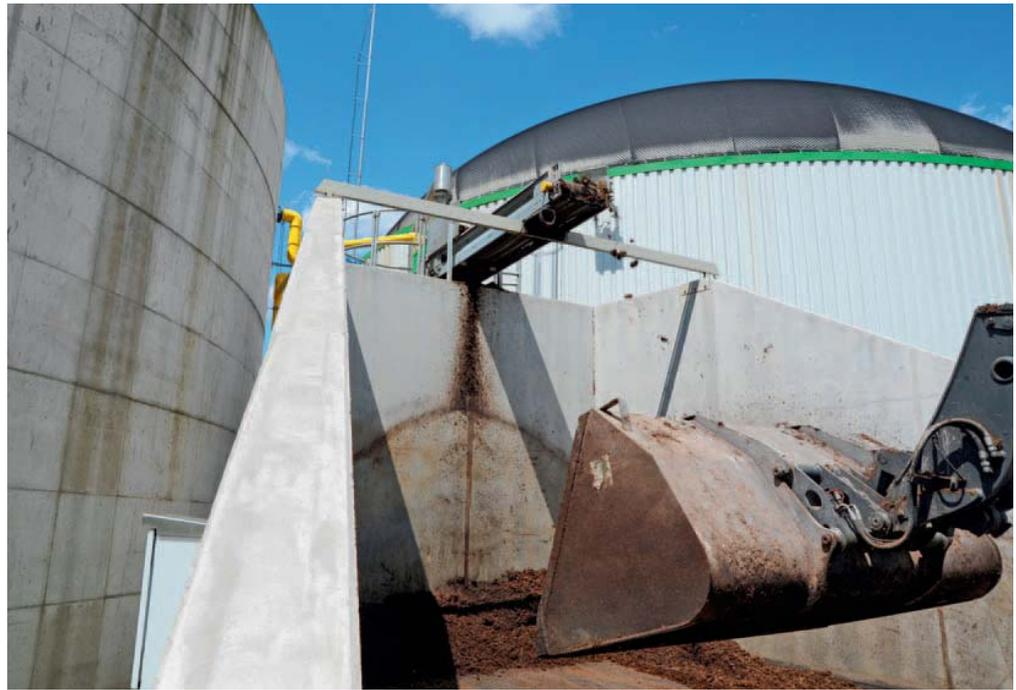
Im Separator wird ein Teil der Gärreste in flüssige und feste (Foto) Bestandteile getrennt. Die flüssige Fraktion geht als Rezirkulat zurück in den Fermenter.
